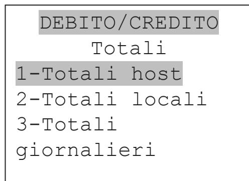
Il totalizzatore host è strettamente legato al Log del terminale e viene utilizzato per il riallineamento dati contabili tra POS e GT.
